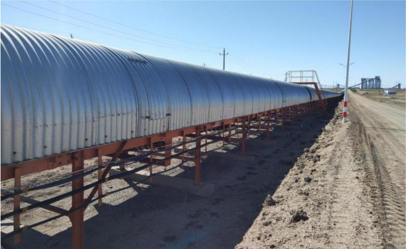
照片 12 皮带输送装置及检修道路
